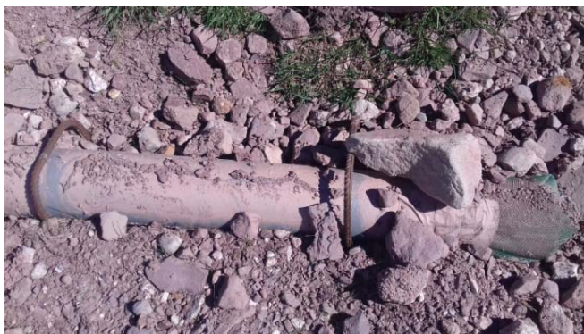
Una de las consecuencias más visibles de la mejora del terreno es sobre el arrastre de suelo. A la dcha uno de los testigos colocados en una zona sin medidas y la izda uno situado en una zona donde se ha colocado una malla orgánica.
